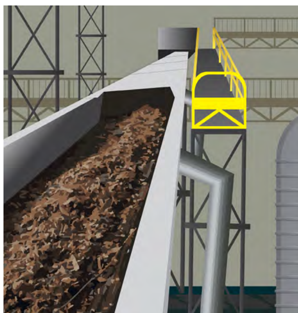
FIGURA 8. Transporte de chips de biomasa mediante correa
