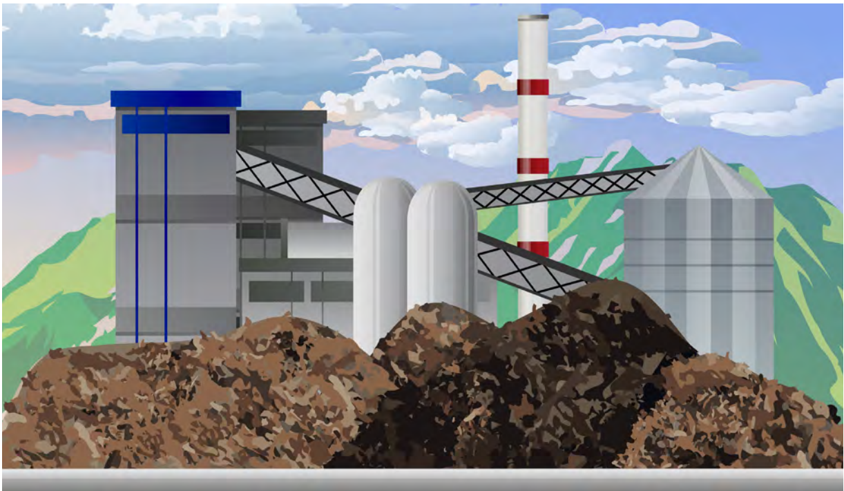
FIGURA 7. Sistema de recepción en patio y acopio en silo de chips de biomasa
